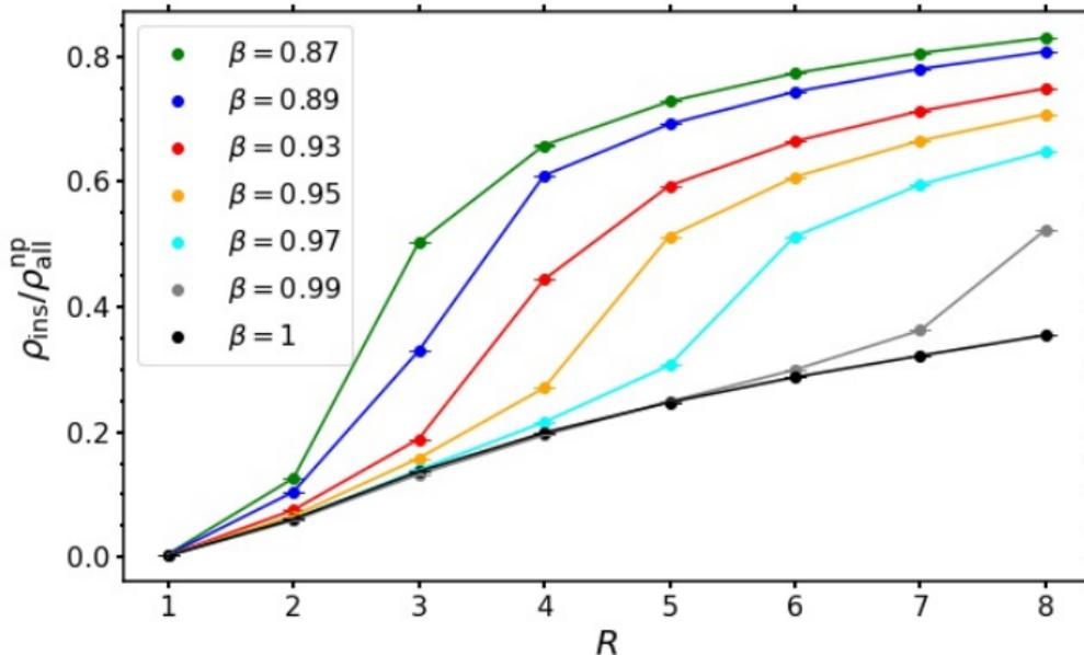
Отношение  $\rho_{\text{ins}} / \rho_{\text{ins}}^{\text{np}}$  монополярной плотности  $\rho_{\text{ins}}$  между пластинами к монополярной плотности в отсутствии пластин,  $\rho_{\text{ins}}^{\text{np}}$  в зависимости от расстояния между пластинами  $R$  для фиксированного набора значений решеточной константы связи  $\beta$ .
