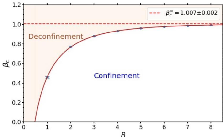
Фазовая диаграмма вакуума компактной электродинамики между идеальными металлическими пластинами на расстоянии  $R$ . Подобранная функция имеет вид  $\beta_c^{\text{fit}}(R) = \beta_c^\infty - \alpha \exp[-(R^2/R_0^2)^\nu]$ ,  $\alpha = 3.7(6)$ ,  $R_0 = 0.28(7)$ ,  $\nu = 0.257(16)$ . Предел при  $R \rightarrow \infty$  изображен пунктирной горизонтальной линией.
