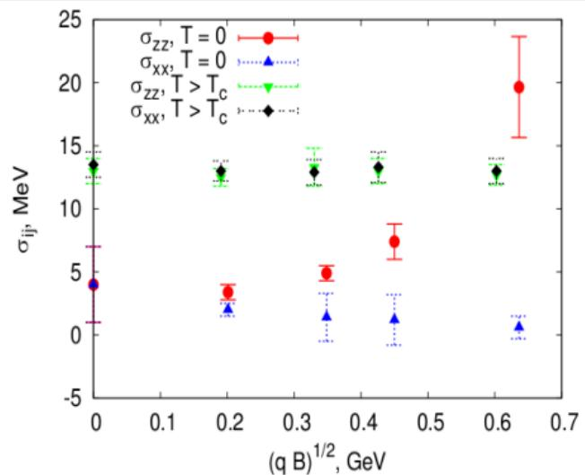
В присутствии магнитного поля при  $T < T_c$  вакуум начинает проводить ток в направлении магнитного поля
