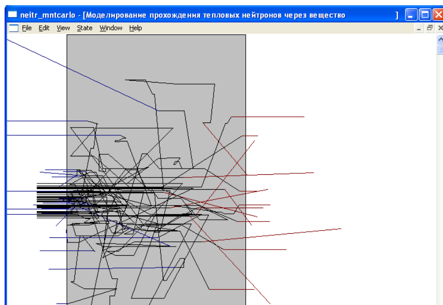
Рис. 1. Пример компьютерного моделирования прохождения нейтронов через вещество методом Монте-Карло.
