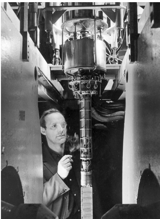
В.П.Алфименков за наладкой рефрижератора с растворением ^3\text{He} в ^4\text{He}
