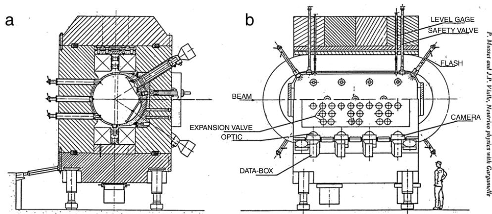
Fig. 20. The Gargamelle bubble chamber.
