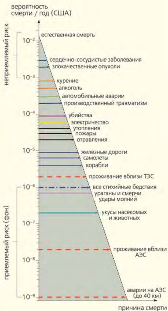
Рис.5. Вероятность смерти человека при различных факторах риска. На 1 ГВт (эл.) в топливном цикле угольных станций гибнет около 300 человек, а в цикле АЭС — в 500 раз меньше.
